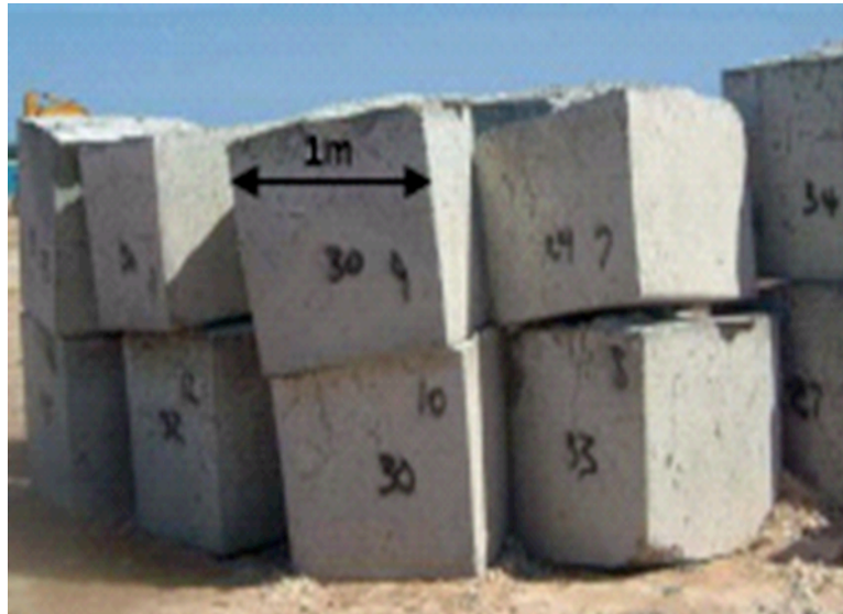
Figura 36 Blocos de concreto feitos de cinzas de WTE usados para proteção e aterro da costa i
